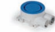
Нижняя монтажная коробка, с двумя ответвителями, расстояние между винтами 60мм, Ø 20 мм AUS6.2 5 вводов с удаляемой мембраной Высота 38 мм
